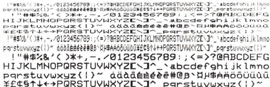
Afb. 3. Met de zelftest wordt de gehele karakterset uitgeprint.
